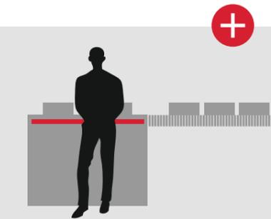
**Keine Unterbrechungen:** Paletten sind in wenigen Sekunden gewechselt. Auf einer Zwischenablage kann der Mitarbeiter weiter kommissionieren, solange die vorherige Palette gestretcht wird. Dies vermeidet unnötige Stillstandszeiten.
