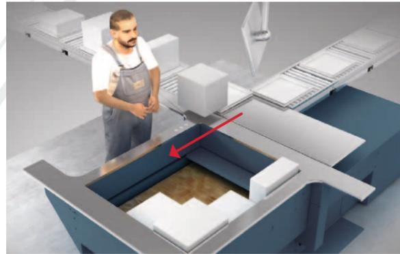
Ist die Palette fertig kommissioniert, wird sie automatisch über den Schacht abgesenkt. Die Schachtwände sorgen dafür, dass die Ladung stabil bleibt. Das ist besonders bei Paletten mit gemischten Waren wichtig. Ein Wickelstretcher umhüllt die Ladung sofort automatisch mit einer Folie, sobald die Palette den Schacht verlässt. So sind die Waren für den Transport vor Verrutschen und Verunreinigungen geschützt.
