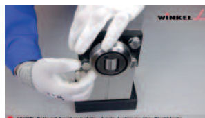
WINKEL-Folie mit Anschraubblech - Axiale Justierung über Stahlbleche
